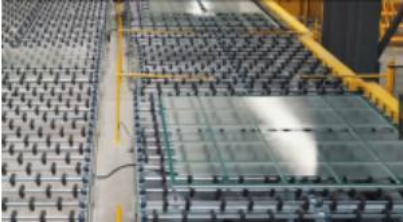
Figure3: Actual Glass on Conveyor Rollers
